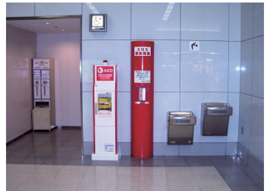
子どもや車いす使用者の利用にも配慮した水飲み場
